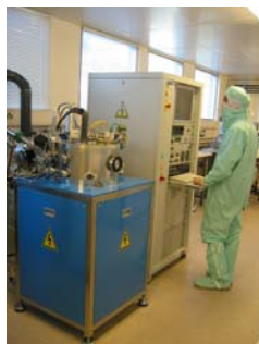
Croissance de NTC par CVD Réacteur PLASSYS compatible 200 mm en salle blanche classe '1000'
