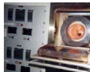
Four tubulaire d'oxydation thermique
