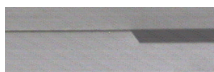
Membrane Si de 2.5µm d'épaisseur
