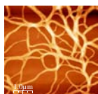
AFM mode tapping QTF8 sur saphire UMR5819-SPrAM
